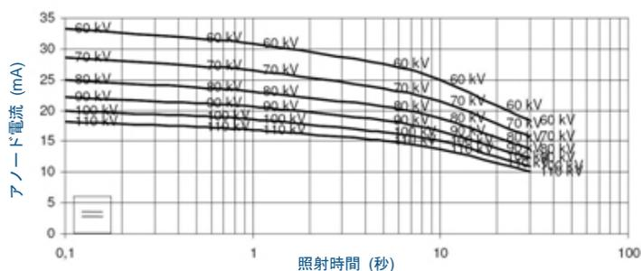
図 12 X 線管のフィラメント放出 : OPX 105
