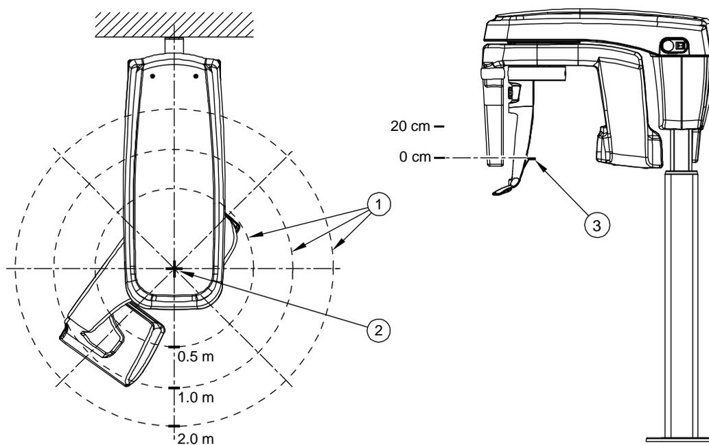
迷放射線はフルパノラマモードで測定され、大型の患者用を選択し、患者の頭をシミュレーションするために PMMA ファントムシリンダー (直径 16 cm、高さ 15 cm) を使用します。
